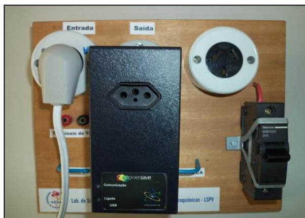
Figura 2. Tomada inteligente Powersave durante testes no LSPV
