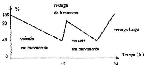
Figura 2 - Recarga das Baterias
