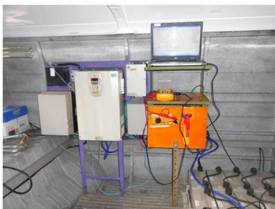
Figura 1.7. ScopeMeter instalado no interior da Kombi durante teste de tração.
