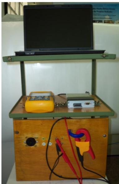
Figura 1.1. Vista frontal da estrutura de suporte de aquisição de dados. Figura: Acervo pessoal.
