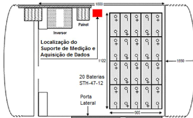
Figura 1.3. Esquema da Kombi com a localização da estrutura de suporte para instrumentos de aquisição de dados
