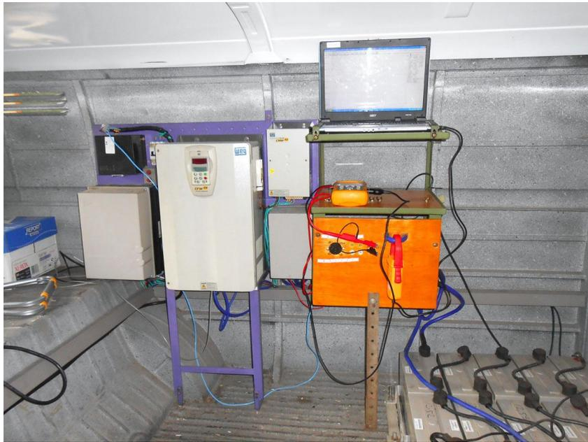
Figura 3.10. ScopeMeter instalado no interior da Kombi durante teste de tração.
