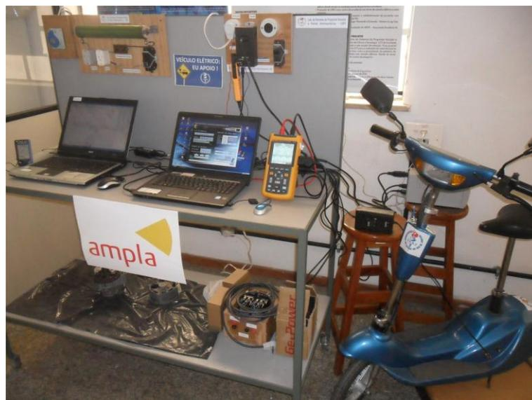
Figura 3.19. Bancada de testes do LSPV com scooter sendo submetida à recarga da bateria.
