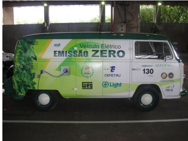
Figura 1.2. Kombi, ano modelo 1982, convertida para tração elétrica.
