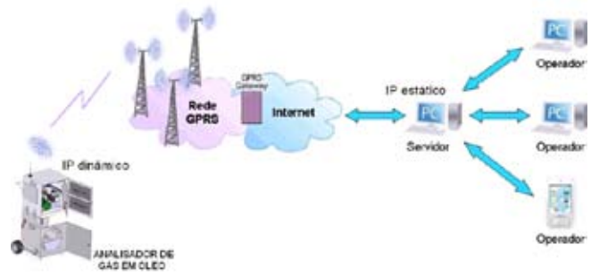
Figura 2 – Topologia do sistema de comunicação GPRS
