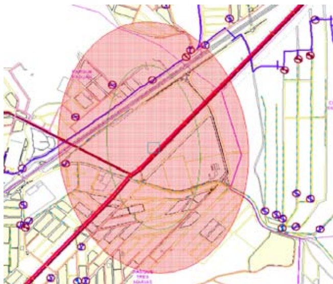
Figura 2. Visualização da área de influência de descarga atmosférica.
