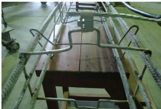
Figura 2. Vista da parte inferior da armação metálica, mostrando a conexão entre o “estribo especial” e os vergalhões.
