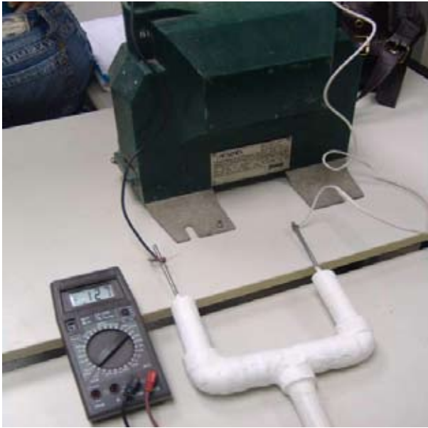
Figura 9. Circuito de testes do divisor de tensão.
