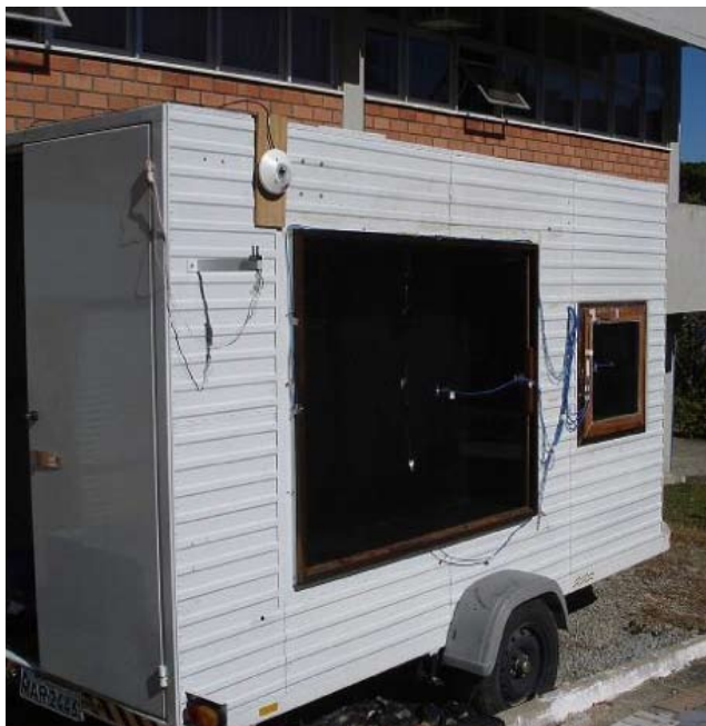
Figura 3. Vista externa do calorímetro durante um teste
