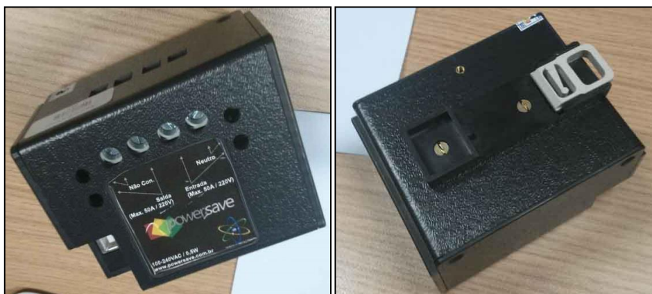
Figuras 3A e 3B. Vistas frontal e traseira do protótipo do medidor Powersave
